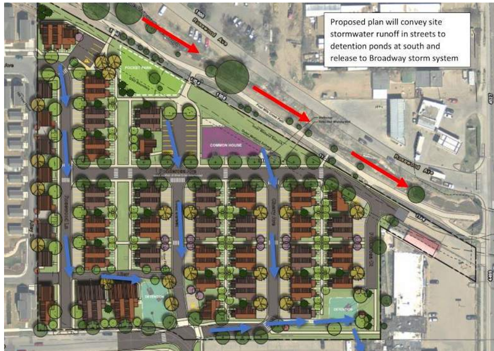
Figura 32 - Escurrimiento de aguas pluviales
